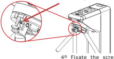
4º Fixate the screw inside the mini arm using a Allen n.8 wrench
